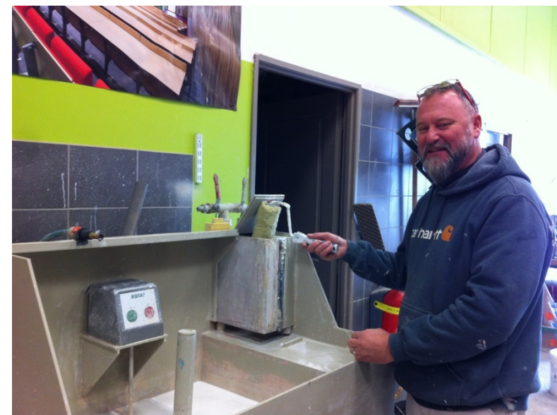
Station de lavage des outils de peinture Recyclage de l'eau et récupération des boues
